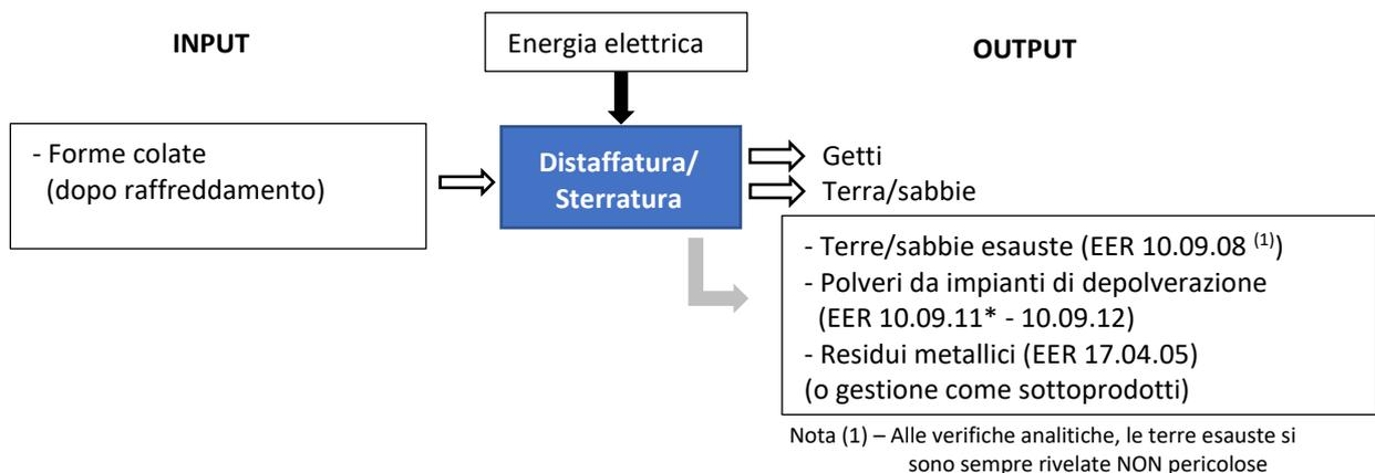
Gli schemi del presente paragrafo riportano riferimenti ai codici EER, nel caso in cui i residui siano gestiti come rifiuti, relativi alla fusione di metalli ferrosi; gli stessi schemi valgono anche per i codici rifiuto originati dalla fusione di metalli non ferrosi, nel caso di produzione di getti con sistemi di formatura "a perdere" in sabbia.
